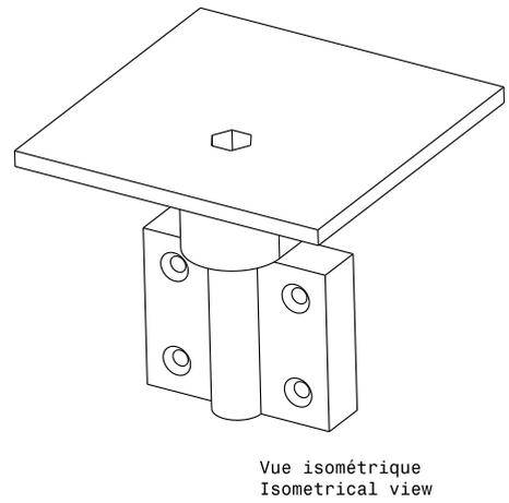
FIGURE 15 : Assemblage panneau solaire
