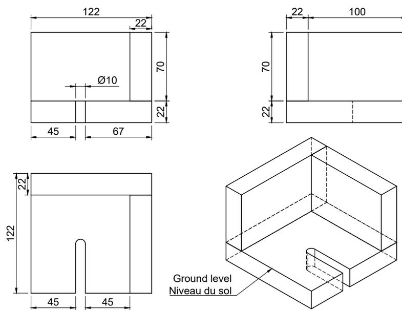
FIGURE 20 : Support de balise fixe droit (Modèle A)
