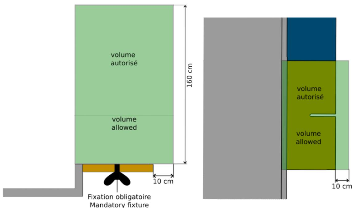
Figure 13 - Principe de fixation du dispositif de calcul déporté
