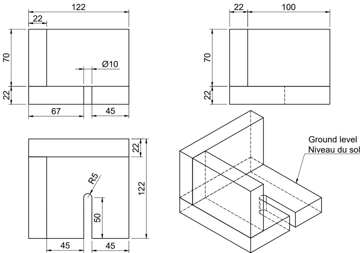
FIGURE 19 : Support de balise fixe gauche (Modèle A)
