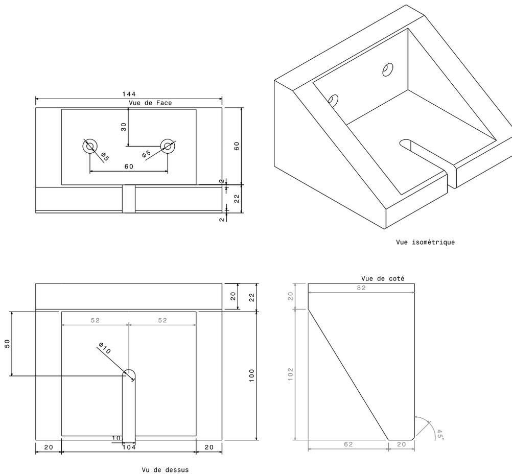
FIGURE 21 : Support de balise fixe (Modèle B)
